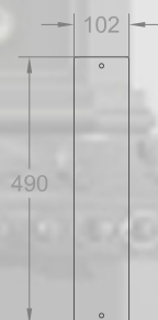
Fuse Box Door
